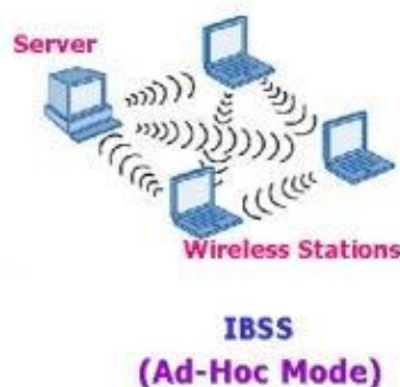
شکل ۲.۳: ساختار شبکه در حالت موردی
